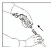
**SPRÜHDÜSE ANSCHLIESSEN** Schlauch an Sprühdüse durch Herunterschieben von Schnellverbinder anschließen.
