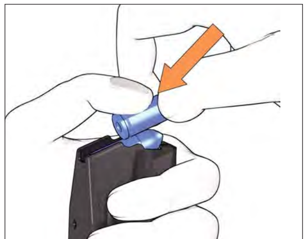
Abb. 29a: Magazin füllen ohne Ladehilfe
