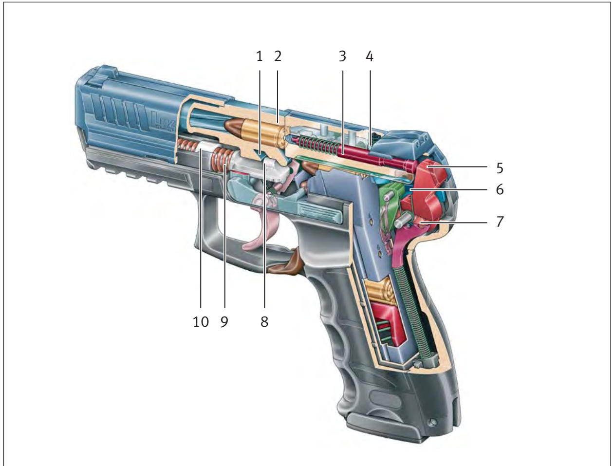
Abb. 13a: Abzugsvariante CDA, Schnittdarstellung
