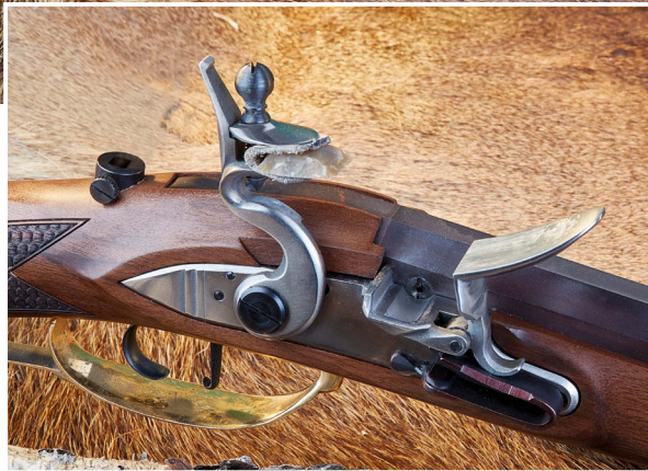
Das Steinschloss: Hahn gespannt, die Pfanne (mit der Friktionsrolle am Batteriefuß) offen, Blick aufs Zündloch.
