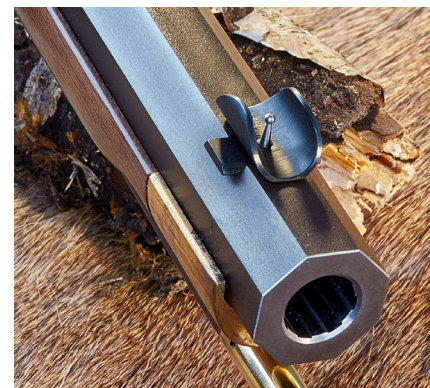
Die Visierung (v.l.): Aufsteckdiopter (nun richtig herum, also für Rechtsanschlag), Standkimme und Perlkorn.
