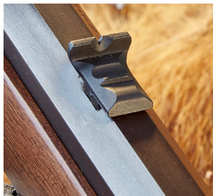
Die Visierung (v.l.): Aufsteckdiopter (nun richtig herum, also für Rechtsanschlag), Standkimme und Perlkorn.
