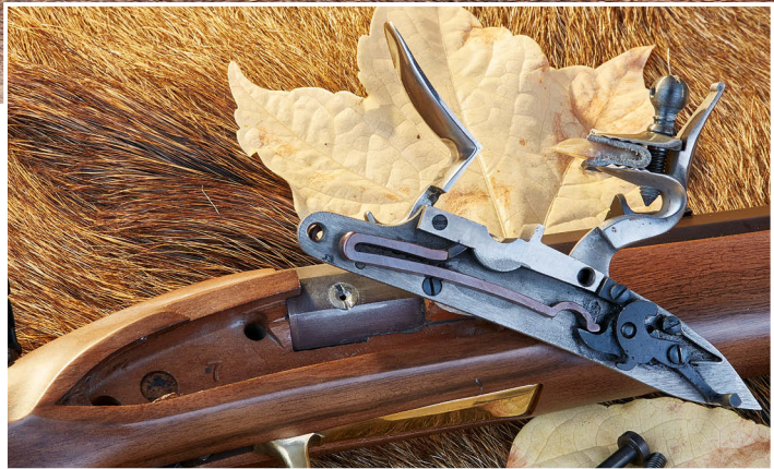
Das Pedersoli-Steinschloss von innen. Die Schlagfeder liegt direkt auf dem Nusskrappen, es gibt keine verbindende Kette.
