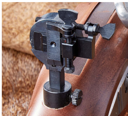
Die Visierung (v.l.): Aufsteckdiopter (nun richtig herum, also für Rechtsanschlag), Standkimme und Perlkorn.
