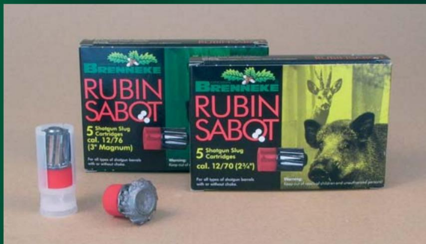
Das RubinSabot ist eine Patrone mit Treibspiegelgeschoss. Dieses ist unterkalibrig und sitzt in einem Käfig aus Kunststoff, der sich nach Verlassen des Laufes aufgrund des Luftwiderstandes vom Geschoss trennt. Durch diese Technologie werden eine höhere Geschwindigkeit und eine größere Reichweite (bis 80 m) des Geschosses erreicht. Die RubinSabot erfreut sich in der Jagdpraxis steigender Beliebtheit und ist aus allen Flintenläufen mit oder ohne Choke universell einsetzbar.
