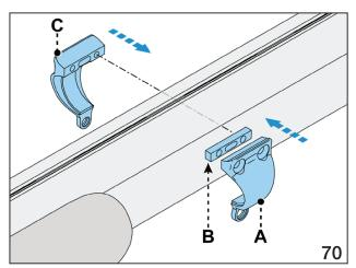
die beiden Schrauben der Halterung anziehen, ohne sie festzuziehen; sicherstellen, dass der Abstand von der Kante des Stabs L = 5 cm beträgt (Abb. 71);
