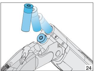
Es ist außerdem wichtig, dass die Hähne nicht leer ausgelöst werden, indem der Abzug betätigt wird, wenn keine Patronen in die Kammer eingelegt sind: Dadurch könnten die Schlagbolzen beschädigt werden.
