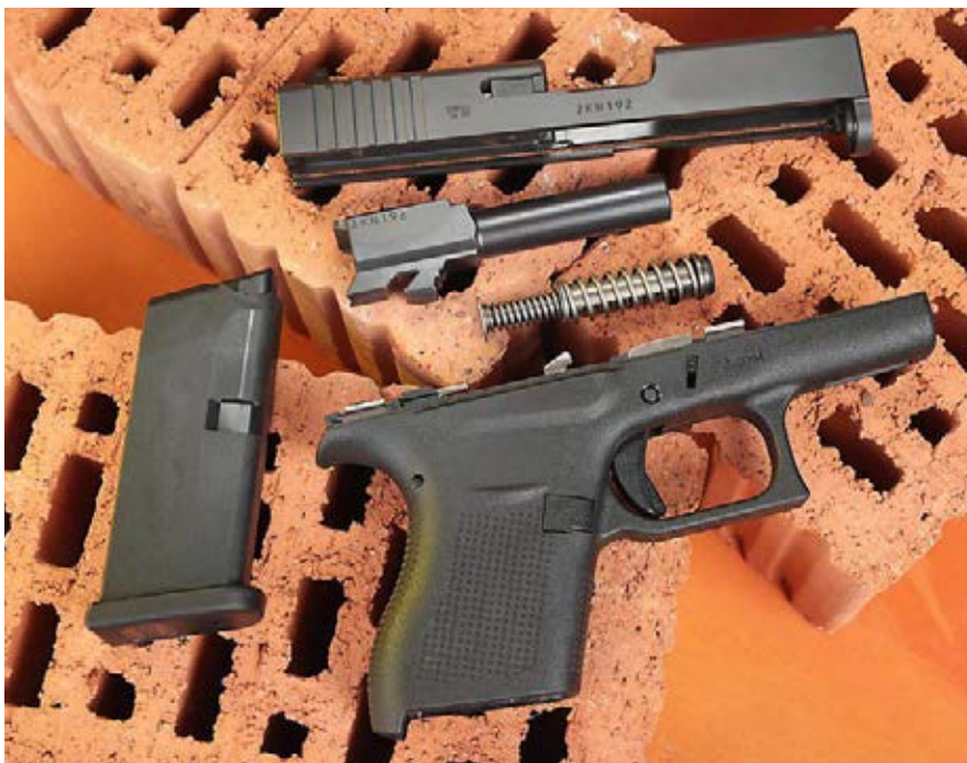
Links: Die Glock 43 geöffnet: Das Patronenlager ist als Riegelblock ausgestattet und trägt am unteren Ende die Steuerkulissee. Von innen zeigt sich die G43 äußerst „Glock-like“.
