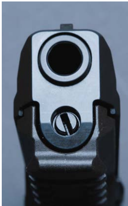
Mündungspartie mit angeschrägten Verschlussflanken, die das Reholstern erleichtern.
