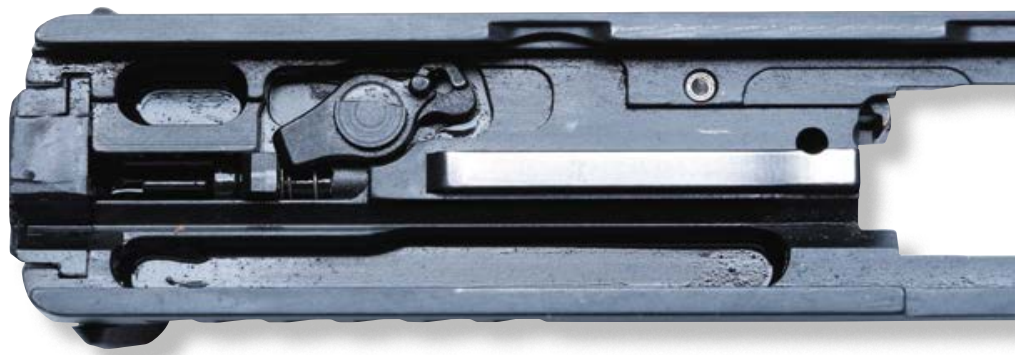
Die im Verschlussheck gelagerte Schlagbolzen-Schlosseinheit im Detail.
