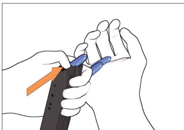
Abb. 38a: Magazin leeren
